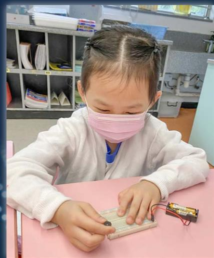
學生從基礎學習中嘗試，利用電池盒、麵包板、麵包板線和LED燈製作閉合電路，令LED燈亮起來。
